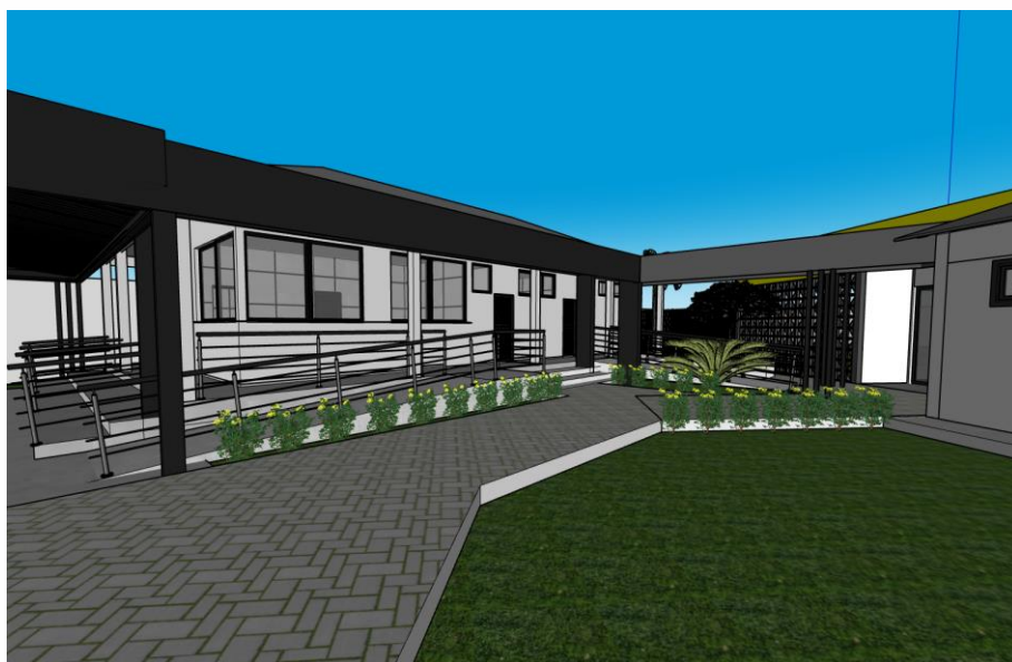
Figura 06 – Passarela de acesso a lanchonete – em estrutura metálica com telha termoacústica com acabamento na parte inferior e superior, pintados na cor preto fosco.
