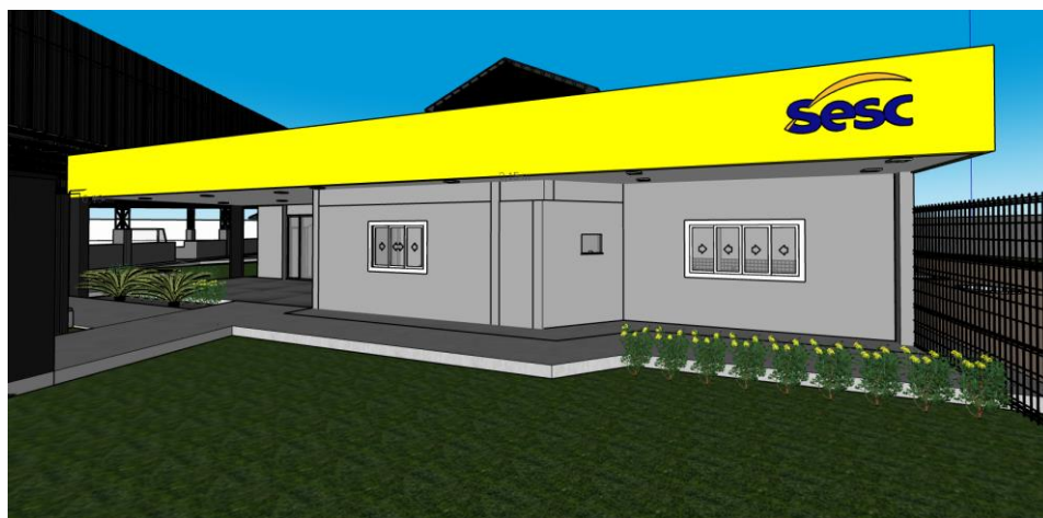
Figura 08 – Cobertura frontal – em estrutura metálica com fechamento em glasroc, telha termoacústica com acabamento na parte inferior e forro de gesso acartonado.
