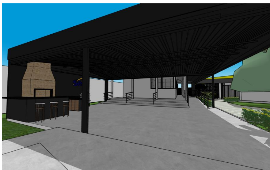
Figura 14 – Pátio coberto lanchonete – em estrutura metálica com telha termoacústica com acabamento na parte inferior e superior, pintados na cor preto fosco. Piso em concreto semi-polido.
