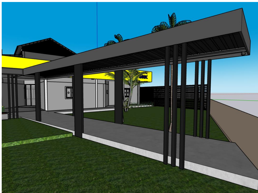
Figura 02 – Passarela de acesso principal – em estrutura metálica com telha termoacústica com acabamento na parte inferior e superior, pintados na cor preto fosco.
