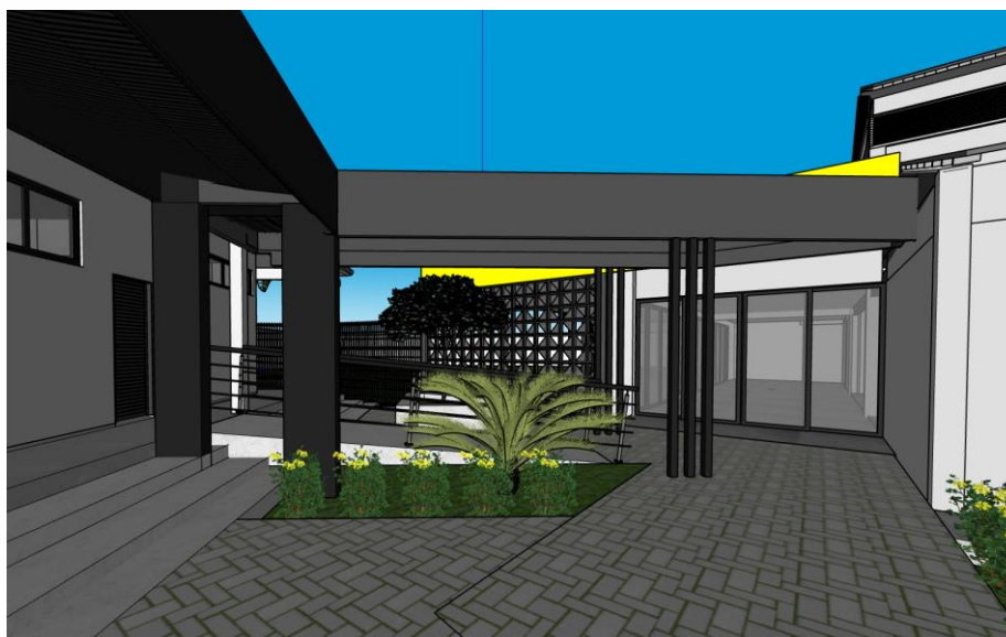
Figura 05 – Passarela de acesso a lanchonete – em estrutura metálica com telha termoacústica com acabamento na parte inferior e superior, pintados na cor preto fosco.
