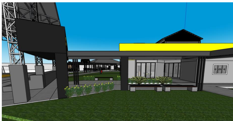
Figura 04 – Passarela de acesso a quadra de esportes – em estrutura metálica com telha termoacústica com acabamento na parte inferior e superior, pintados na cor preto fosco.
