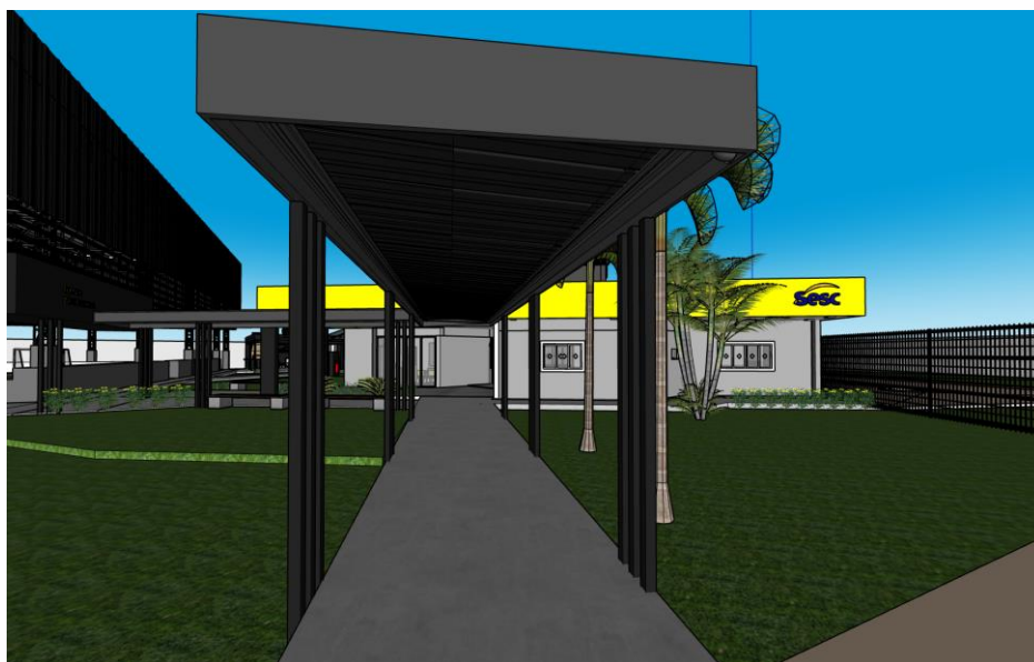
Figura 03 – Passarela de acesso principal – em estrutura metálica com telha termoacústica com acabamento na parte inferior e superior, pintados na cor preto fosco.
