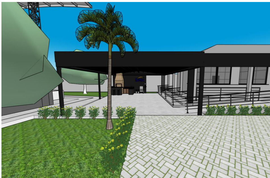
Figura 12 – Pátio coberto lanchonete – em estrutura metálica com telha termoacústica com acabamento na parte inferior e superior, pintados na cor preto fosco.
